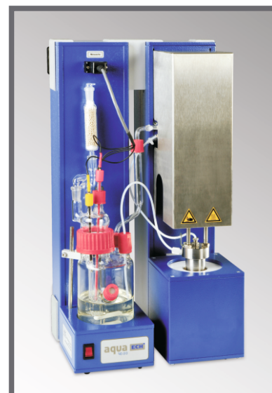
AQUA 40.00 с модулем для парофазного дозирования проб - версия без автосамплера
